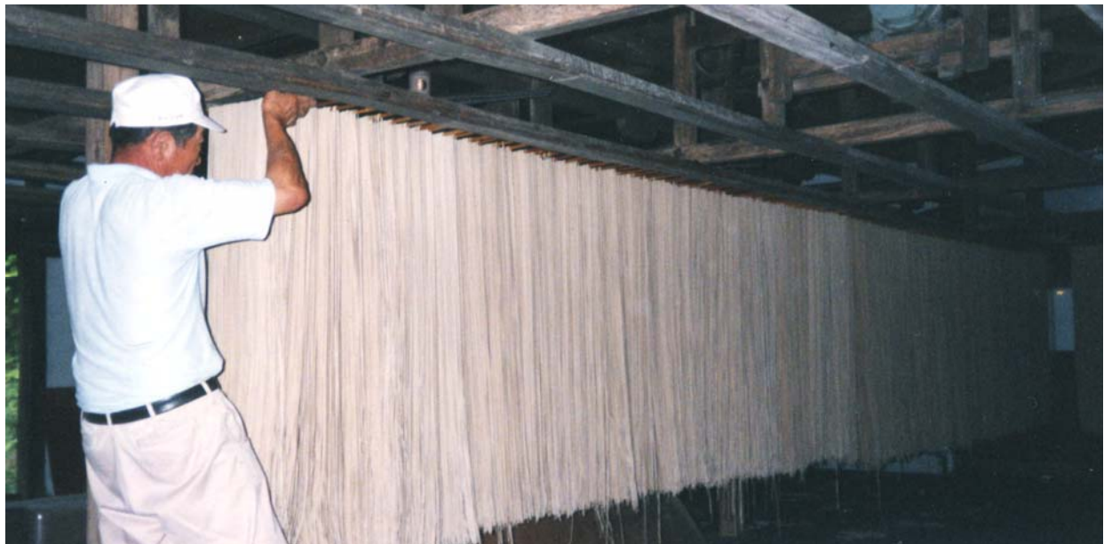
大谷製麺工場。竹の棒に二つ折りにぶらさげた生そばを等間隔に並べて乾す。天井には大型の扇風機。乾燥後は再び同様の姿勢で外し、裁断、袋詰めの作業へと進む。大半が肉体労働。
