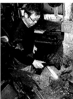
堺市堺区の工房で、窯から取り出した鉄板をハンマーで打つ堺打刃物職人の榎並正さん
